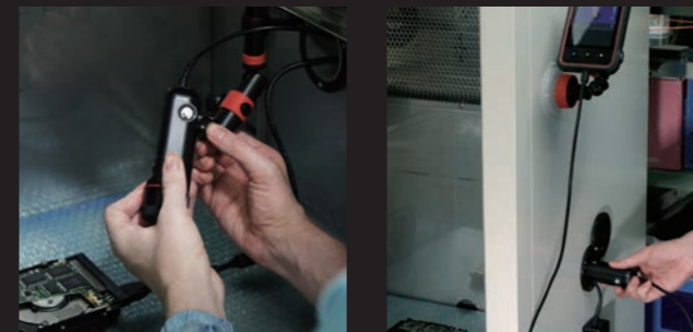
小型のカメラヘッドを恒温槽などの設備の中に入れることも可能。外に出したコント ローラで計測状況を確認しながら、タッチパネルで遠隔操作を行うこともできます。
