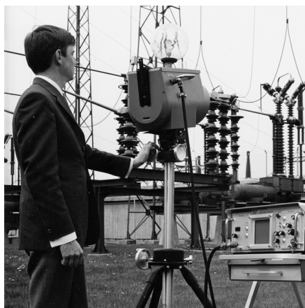
1969 年: Thermovision モデル 661。カメラの重量は約 25 kg、オシロスコープは 20 kg、三脚は 15 kg です。操作するには、220 VAC ジェネレーター式と 10 L の液体窒素が必要でした。オシロスコープの左にはポラロイドカメラ (6 kg) が取り付けられているのが見えます。
