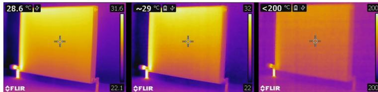
図 31.4 FLIR T440 で撮影した画像。温度範囲はそれぞれ  $-20 \sim +120^{\circ}\text{C}$  (左)、 $0 \sim +650^{\circ}\text{C}$  (中央)、 $+250 \sim +1200^{\circ}\text{C}$  (右)。これ以外の設定は何も変更されていません。
