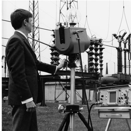
図 33.2 1969: Thermovision Model 661。カメラの重量は約 25 kg、オシロスコープは 20 kg、三脚は 15 kg です。オペレータは 220 VAC ジェネレーターセットと、液体窒素の入った 10 L 容器も必要です。オシロスコープの左側には、ポロイドのアタッチメント (6 kg) があります。
